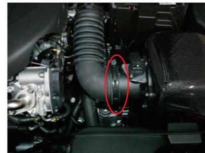
16.エアホースをエアフローアダプターに差し込みホースクランプを締めこみます。
