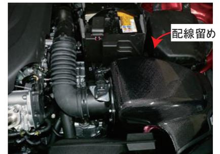
18.エアフローセンサーコネクタを差し込み、エアフローセンサーの配線留めをカーボンケースに取付ます。カーボンケースとバッテリーのクリアランスが狭い場合はバッテリーを奥側にずらしてください。
