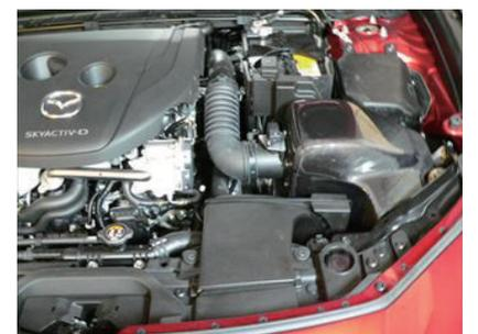
15.カーボンケースを車両にステーを調整しながら配置します。ゴムブッシュがしっかり車両側の凸部に刺さっている事を確認してください。
