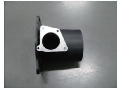
8.ビスC×2を使用して、エアフローアダプターに変換プレートを取付けます。
