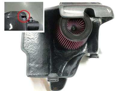
13.ファンネルアダプターにエアフィルターを取付ます。ケース横のサービスホールでバンドを締めつけ固定します。
