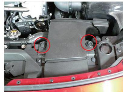
17.フレッシュエアダクトを取外したボルトで固定します。
