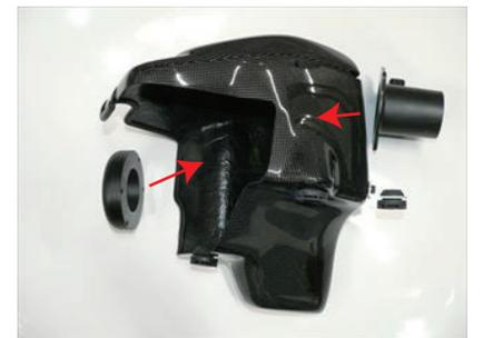
12.ファンネルアダプターとエアフローアダプターをカーボンケースを挟み込むようにビスA×4で固定します。
