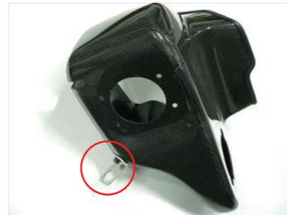
10.カーボンケースにビスA×1を使用して、ステーを取付けます。ステーの向きは写真を参考にしてください。
