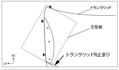
1. トランクリッド表面に付属の型紙を使用して、取付穴の位置をマーキングします。
