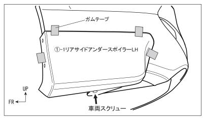
2. ①-1リアサイドアンダースポイラーLHをリヤ・バンパ に仮合わせします。1.で取り外した車両スクリューを 使用して仮止めし、位置が決まったらガムテープ等で 仮固定します。
