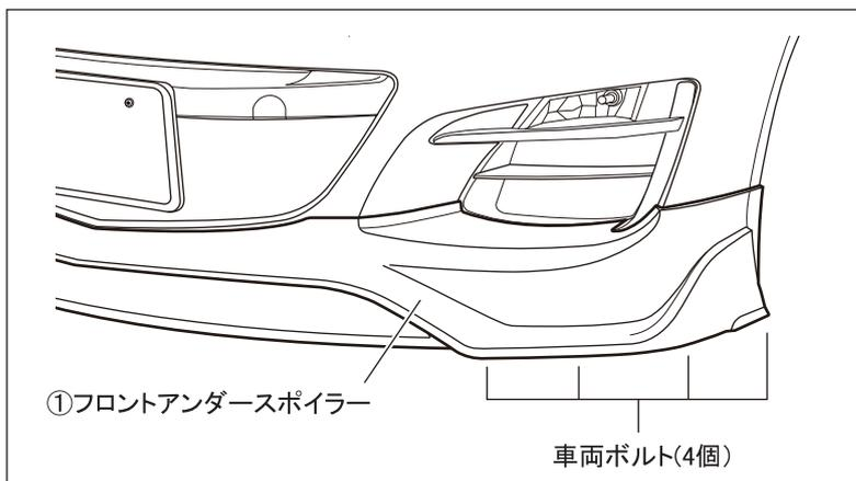
11. 10.で仮締めした車両ボルト（再使用：左右各 4 ヶ所）を本締めします。
