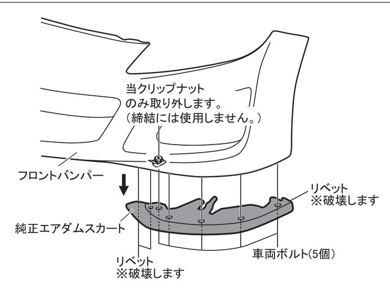
2. 純正エアダムスカートを固定しているボルトを取り外しリベットを破壊します。
