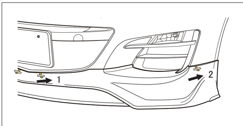
11. ①フロントアンダースポイラーの両面テープ離型紙を中央から外側へ左図の順番で引き抜きながら貼付け面を十分に圧着します。
