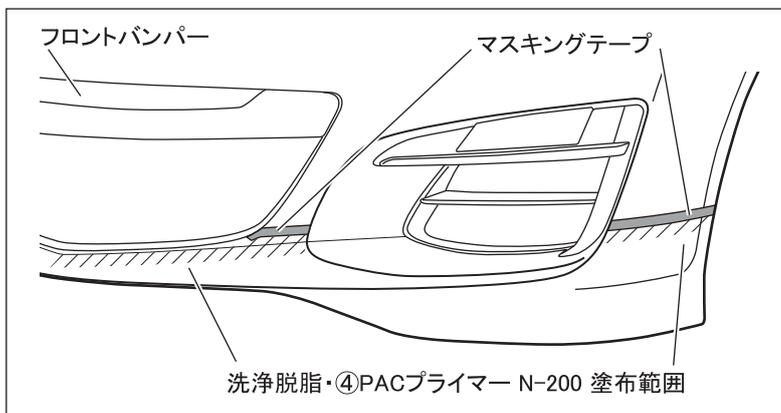
6. フロントバンパーの両面テープ貼付け部(左図斜線部)を洗浄脱脂し、④PACプライマー N-200 を塗布します。
