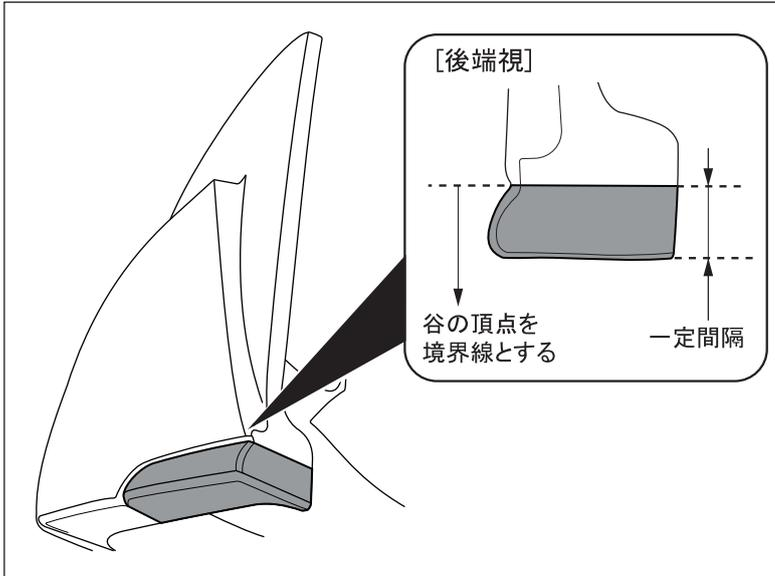
1. 翼端下部を図示の通りにツヤ消しブラックで塗装します。
