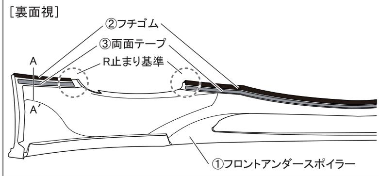
7. ①フロントアンダースポイラーの②フチゴム、③両面テープ貼付け部を洗浄脱脂し、同品を貼付けます。
