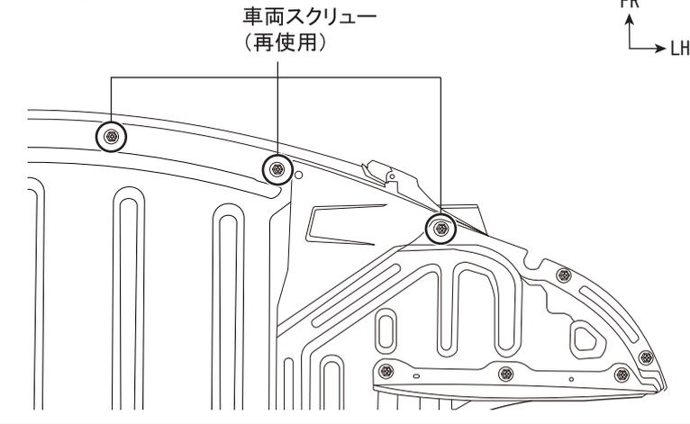
1. フロントバンパー下面、アンダーカバーの車両スクリューを取り外します。(左右各 3 ケ所)
