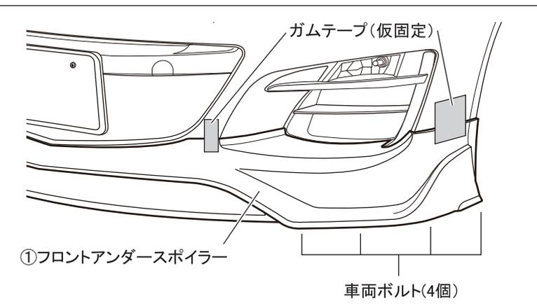
4. ①フロントアンダースポイラーの上端に合わせてフロントバンパーにマスキングテープを貼り付けます。
