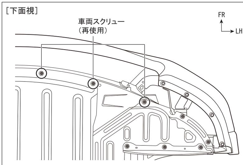
12. 1.で取り外したフロントバンパー下面、アンダーカバーの車両スクリューを取り付けます。(左右各 3 ヶ所)
