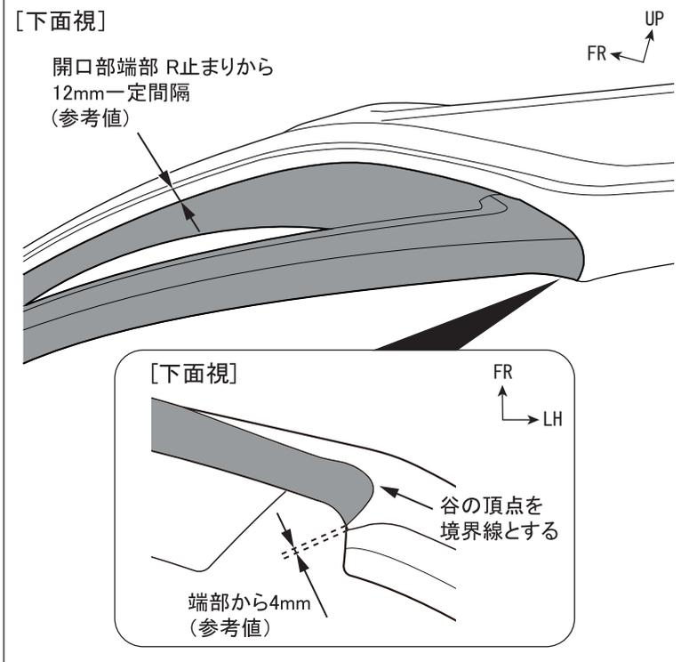
2. 中央開口部を図示の通りにツヤ消しブラックで塗装します。
