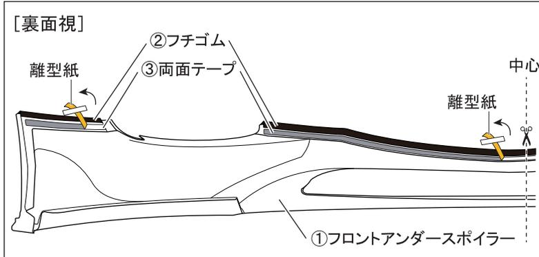
8. ①フロントアンダースポイラーの両面テープ離型紙を左図のように30mm程度剥がし、表側へ折り返してマスキングテープで固定します。(左右各2ヶ所)
