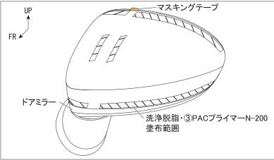
3. 車両ドアミラーの両面テープ貼付け部(左図斜線部)を 洗浄脱脂し、③PACプライマーN-200を塗布します。
