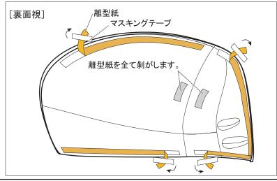
4. ①ドアミラーカバー 裏側の両面テープ離型紙を30mm 程度剥がし、表側へ折り返してマスキングテープで 固定します。
