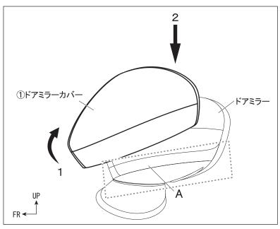
5. 車両ドアミラーに①ドアミラーカバー を仮あてします。 この際、左図のように①ドアミラーカバー 下端から車両 ドアミラーに被せながら、A部を下図の通り、車両ドアミ ラーの塗装部の端部に合わせ、塗装部が隠れるよう調 整しながら、位置を決めます。
