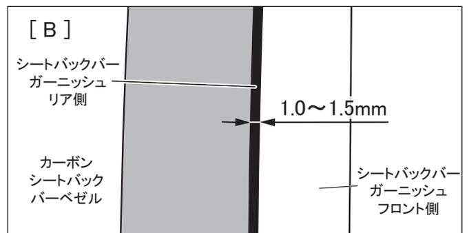
5. カーボンシートバックバーベゼルが動かないように注意しながら、剥離紙を引き抜き、中央から外側に向かってカーボンシートバックバーベゼルを固定します。
