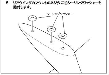
※穴開加工箇所はタッチアップペイント等で防錆処理を施して下さい。
