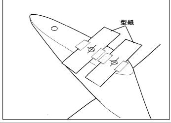
1. で開けた穴に付属ボルトを使用してリアウイングを仮付け し、位置を決定後、型紙をトランク側にガムテープで固定します。リアウイングに貼付したセロハンテープをゆっくり剥がしな がらリアウイングを一旦取り外し、型紙の穴位置にポンチを使 用してマーキングを施し、φ8の穴開加工をします。(左右各2 箇所)※中央穴は裏骨まで貫通させます。
