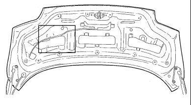
2. 別紙の型紙を切り抜き、リアウイングのマウントの後側の穴 位置にセロハンテープなどで軽く貼付します。(片側2箇所)
