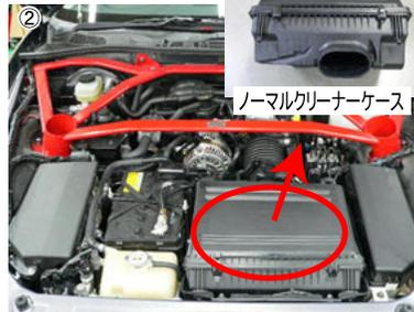
② エアフロセンサーのカプラーを外し、ノーマルクリーナーケースASSYを取り外します。
