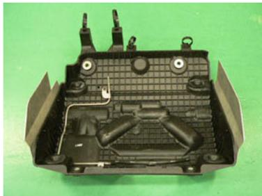
④ インシュレーターに付属ヒートプレートを左右に取り付けます。
