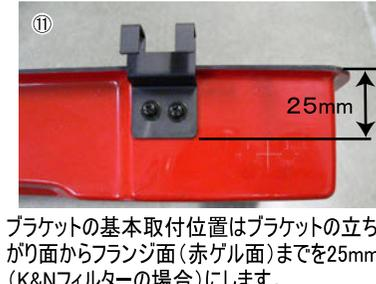
⑪ ブラケットの基本取付位置はブラケットの立ち上がり面からフランジ面(赤ゲル面)までを25mm (K&Nフィルターの場合)にします。 ※純正フィルターや社外フィルターと組み合わせて使用する場合は、フックに適度なテンションが掛かる位置で取り付けます。
