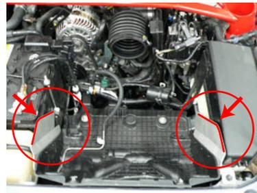
⑥ インシュレーターを元の位置に取り付け、ヒートプレート上部にミソゴムを貼り付けます。
