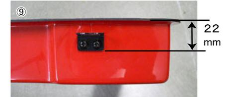
⑨ ブラケットの基本取付位置はブラケットの立ち上がり面からフランジ面(赤ゲル面)までを22mm (K&Nフィルターの場合)にします。 ※純正フィルターや社外フィルターと組み合わせて使用する場合は、フックに適度なテンションが掛かる位置で取り付けます。
