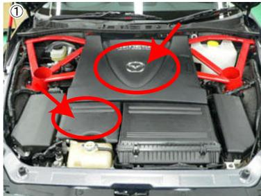
① エンジンカバーとバッテリーカバーを取り外します。
