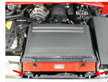
⑳ 組み立てたインダクションボックスASSYをインシュレーターに4箇所穴に差し込み、同時にノーマルインテークホースに取り付けます。
