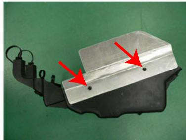
⑤ ヒートプレートを当てがい、インシュレーターに3.2mmの穴を開けて、M3ビス、ナットで取り付けます。
