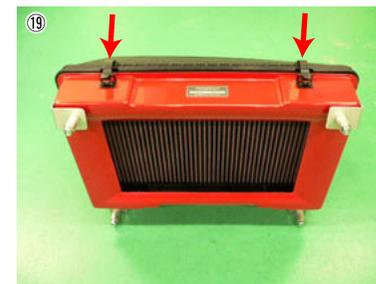
⑲ 純正エアクリーナーカバーにフィルターを挟み、フィルターカバーを仮組みします。フックに適度なテンションが掛かる位置で各部を増し締めします。
