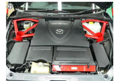
㉑ エンジンカバーとバッテリーカバーを取り付け、作業完了です。
