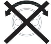
右図 A部分に、上図形状のヘッド形状をしたボルトが組まれています。これは、ショックアブソーバー本体を分解および、組立をする際のガスの通路を密封するためのボルトです。本キットのショックアブソーバーには、非常に高圧のガスが封入されており、この部分を緩めると、重大な事故や、パーツの破損につながります。絶対に緩めないで下さい。
