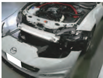
1. 車輻からフロントバンパーを取外します。
