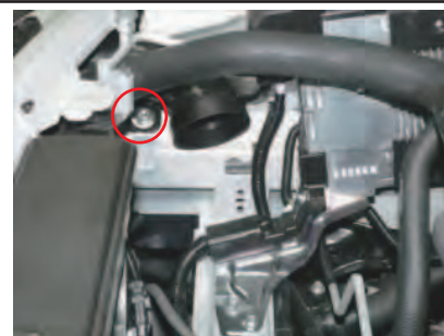
3. 純正フレッシュエアードクトを取外すため、○印部のスクリューを取外します。
