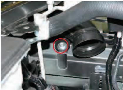
4. 純正フレッシュエアダクトを取外すため、○印部のスクリューを取外します。
