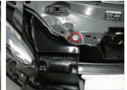
7. ビスF・M3ナットを使用して、フレッシュエアダクトにカーボンステアAを取付け、図示の位置(フレッシュエアダクトがバンパーレインフォースメントに接する部位)に両面テープを貼付けます。
