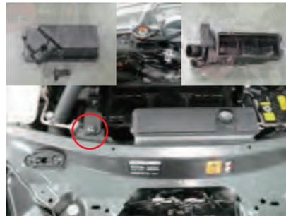
2. エアクリナーカバーとエアクリナーエレメントを取外し、エアフローセンサーを取外します。次に、○印部のスクリューを取外し、エアクリナーケースを取外します。
