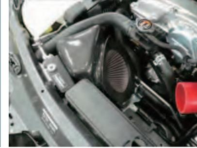
10. ビスAを使用して、カーボンダクトケースRHにカーボンステアBを取付けます。
