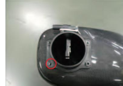
14. ビスAを3本使用してカーボンダクトケースLHにエアフローアダプタを取付けます。○印部のビスを取付けません。
