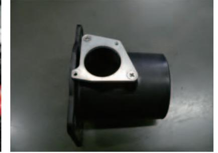
12. ビスEを使用して、エアフローアダプタに変換プレートを取付けます。
