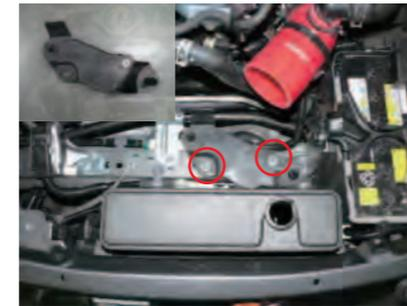
3. ○印部のスクリューを取外し、エアクリナーブラケットを取外します。
