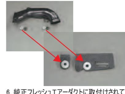
6. 純正フレッシュエアダクトに取付けられているマウンティングブラバーおよびスペーサーを取外し、カーボンステア A・B にそれぞれ移設します。
