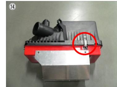
この段階で一度フィルター、フィルターカバーを取付けて、クリップのテンションを確認してください。
