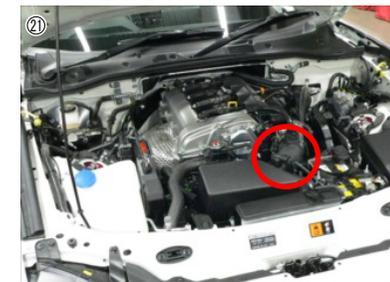
エアフローセンサーを車両に復元し、ラジエターリザーバータンクのキャップを閉め、作業完了です。
