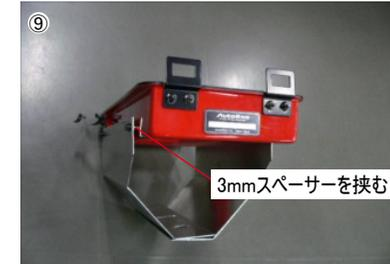
ヒートプレートの間に3mmスパースーを挟みます。C面も同様に取付けます。
