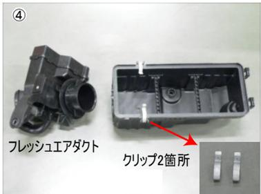
エアークリーナーケースから、フレッシュエアダクトを取外します。同時にクリップ2箇所を取外します。
