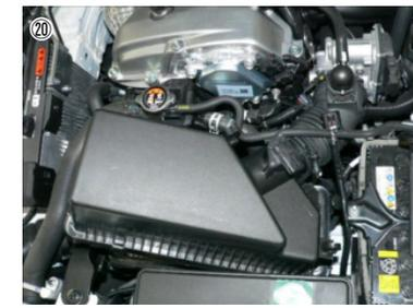
エアホースにエアークリーナーカバーを取付けます。エアークリーナーカバー右側の爪をブラケットBの穴に挿入してカバーを閉め、クリップ2箇所を固定します。
