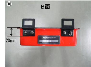
ブラケットBを取付けます。(ブラケットBの基本取付位置は上図を参照)
