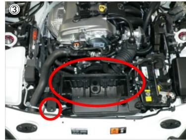
フレッシュエアダクトの固定ボルトを外し、エアークリーナーケースを取外します。
