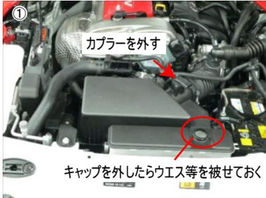
エアフローセンサーのコネクタを外し、エアホースのホースクランプを緩めます。ラジエターリザーバータンクのキャップを外します。
