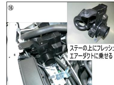
写真を参照しフレッシュエアダクトの溝にアルミステーを挟むように乗せます。
