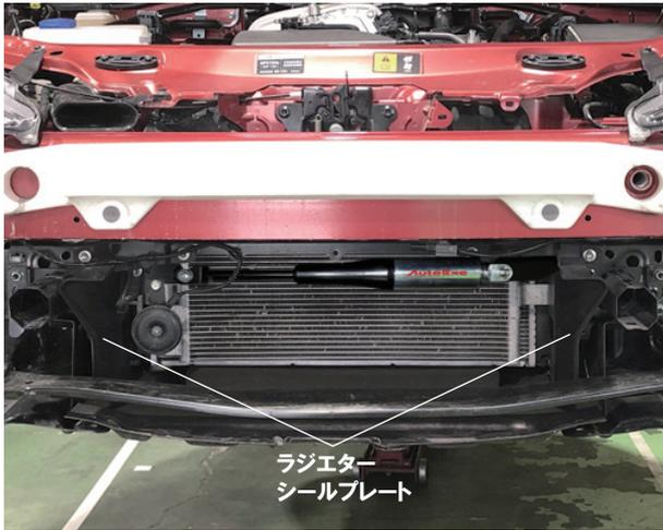
10. ラジエターシールプレートを復元したのち、フロントバンパーを車両に復元します。
