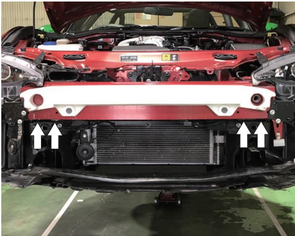
3. フロントクロスメンバーを固定している図示部のボルト4本を取外し、②フロントブラケット・RHおよび③フロントブラケット・LHを純正ボルトを使用して取付けます。
