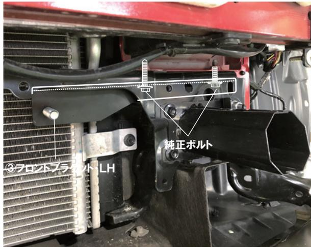
7. 純正ボルトを使用して、③フロントブラケット・LHを車両に仮組みします。
