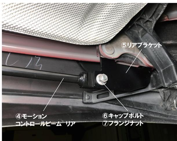
14. ④モーションコントロールビーム リアが⑤リアブラケット・RHの後方に位置するように配置し、⑦キャップボルトおよび⑧フランジナットを使用して仮組みします。
