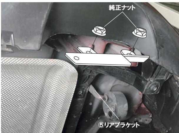
12. 純正ナットを使用して、⑤リアブラケット・RHを車両に取付けます。
