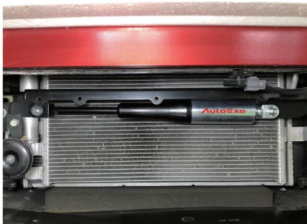
8. ①モーションコントロールビーム フロント(L=430)のダンパー部が助手席側に位置するようにブラケットに配置し⑧フランジナットで仮組みします。
