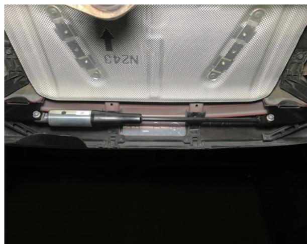
15. ⑦キャップボルトおよび⑧フランジナットを規定トルクで本締めして作業完了です。
