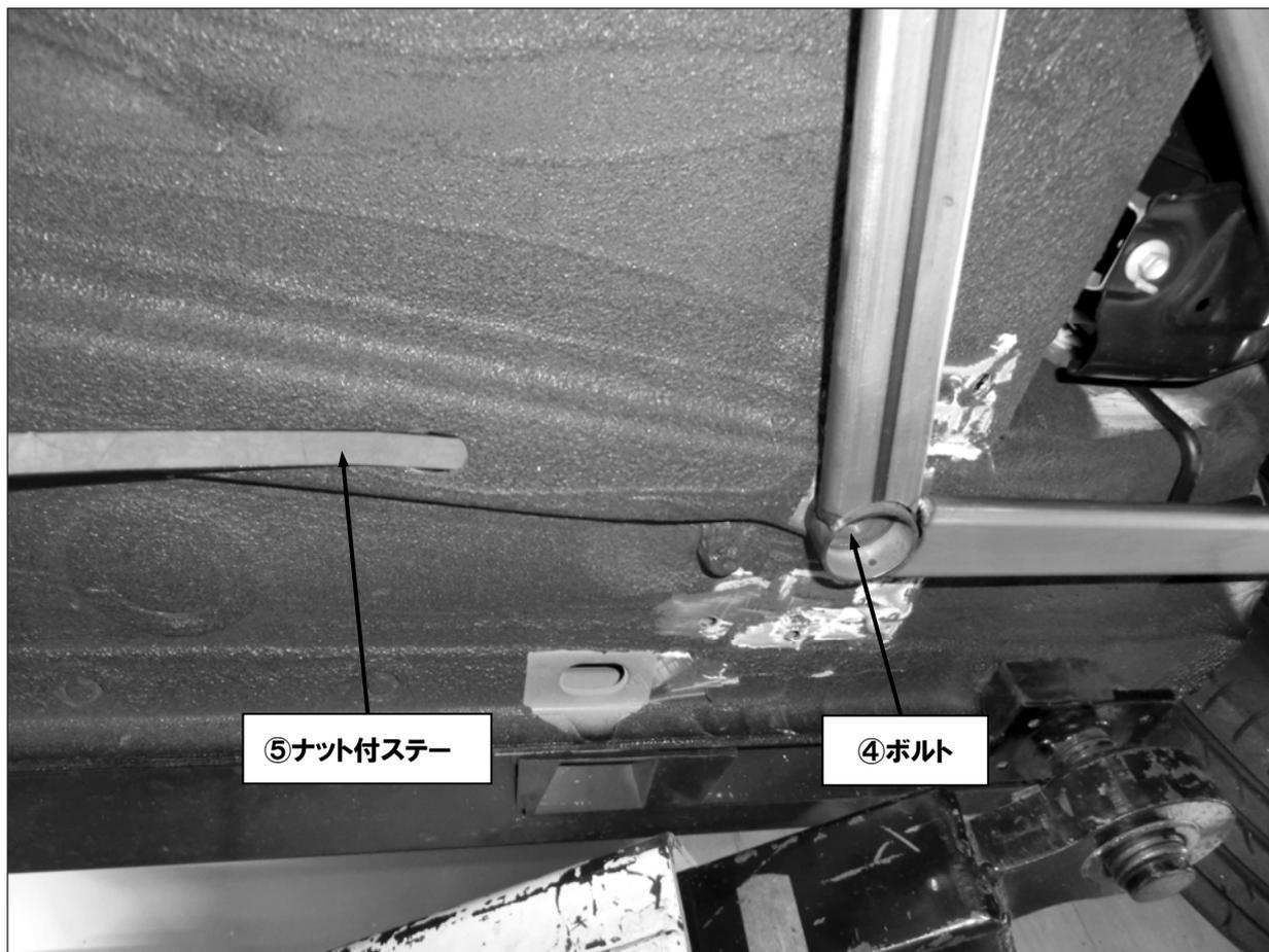
7. 純正ボルトを使用して、センターアンダーカバーをメンバーブレースに固定して作業完了です。
