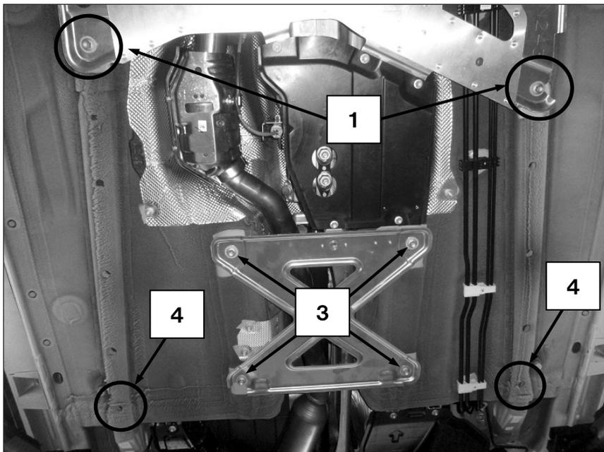
5. リヤサスペンションメンバーを固定しているナット2個を取外します。
