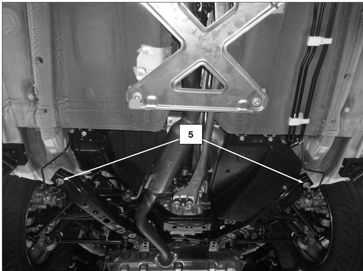
6. 取外した純正ボルトおよびナット、④ボルト、⑤ナット付ステーを使用してメンバープレースを取付けます。
