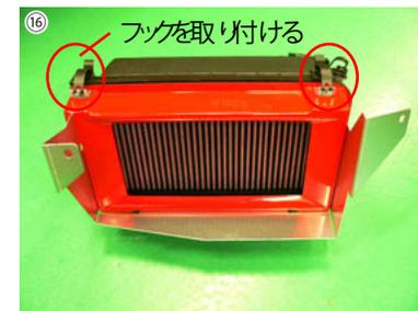
⑯ ノーマルケース (エンジン側) にフィルターを挟み、カバーを仮組みします。フックの適度なテンションが掛かる位置で各部を増し締めします。
