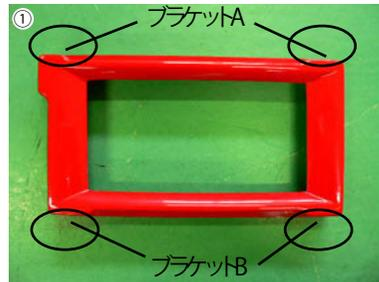
① フィルターカバーの上側にプラケットA・下側にプラケットBを取り付けます。
