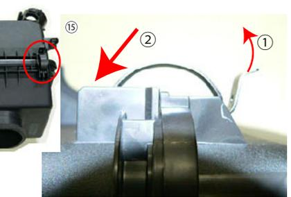
⑮ フックを起こして、下に強押しして取り外します。
