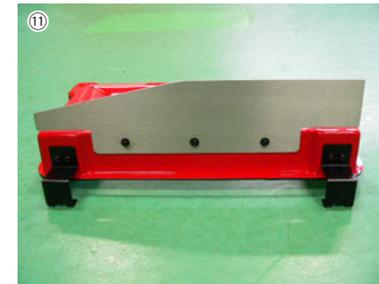
⑪ 下側にヒートプレートAを取り付けます。(M3ビス・M3ナットを使用)
