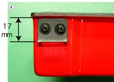
④ プラケットの基本取付位置はプラケットの立ち上がり面からフランジ面 (赤ゲル面) までを17mm (K&Nフィルターの場合) にします。
