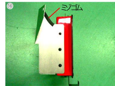
⑬ 横側にヒートプレートCを取り付けます。上にミノゴムをカットして貼り付けてください。
