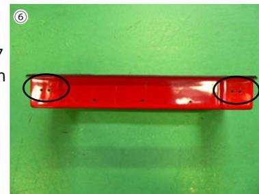
⑥ 下側にプラケットBを取り付けます。(M3ビス・ナットを使用)
