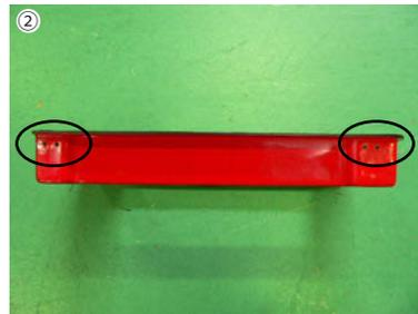
② 上側にプラケットAを取り付けます。(M3ビス・M3ナットを使用)
