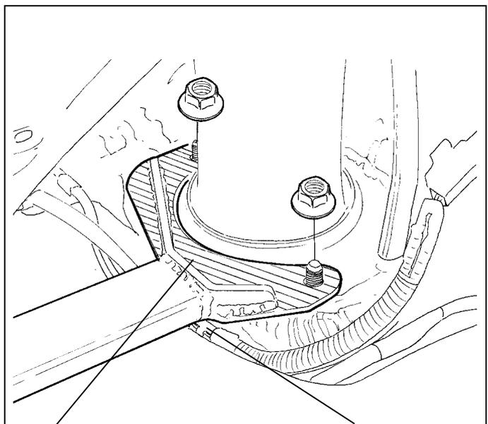
斜線部の下にあるシリコンシーラーを除去してボディに直接マウントする。
