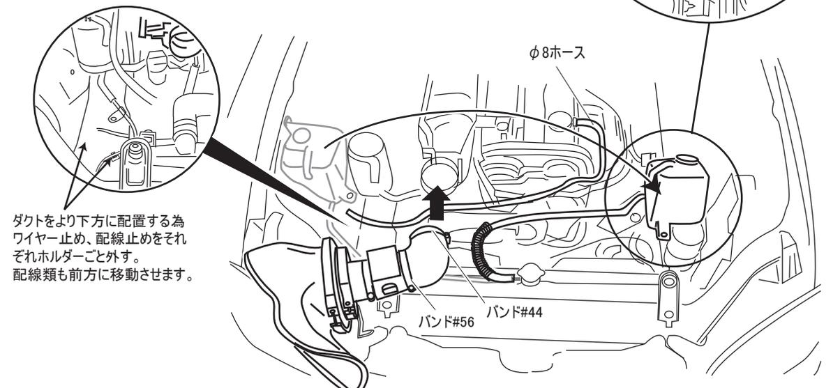
※ダクトは目一杯下に押し込むようにしてバンド固定して下さい。
