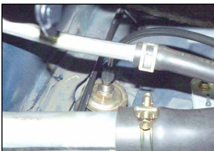
付属の③6角レンチを使用して、⑬減衰力調整ケーブルをダンパートップの6角シャフト部に取付けます。
