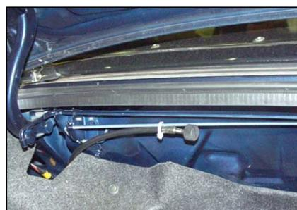
トランクトリムの隙間から⑬減衰力調整ケーブルをトランク側に出し、④タイラップを使用して、トランクバランススプリングに固定します。
