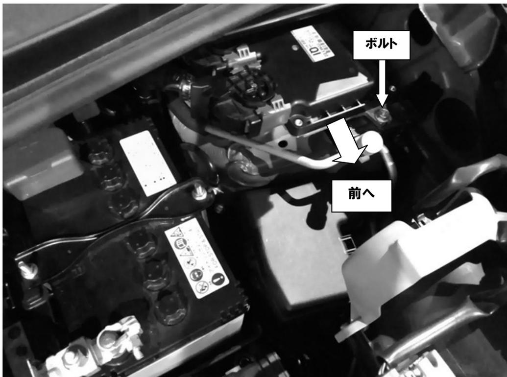
2. アッパーマウント部穴を利用し、②ボルト付ステーをフェンダー内部から差込み、③フランジナットでストラットタワーバーを仮取付けし、周辺パーツと干渉していない事を確認し締付固定します。
