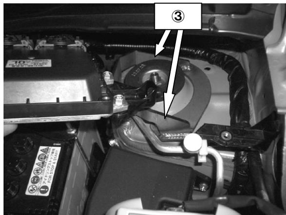
3. 1.で引き出したエンジンコンピューターの奥を元のステーに差込み、ブラケットとの間に⑤スペーサーを挿入して、④ボルトで取付けます。
