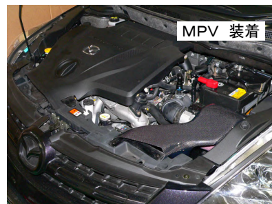
11: 各部、クリアランスを確認しながら増し締め固定します。
