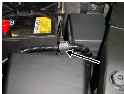
2: 純正エアクリーナーボックスから配線を外します。
