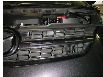
5: フロントグリル部を手前に引き開けながら、グリルブラケットの6ヶ所のタッピングビスを外します。
