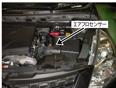
1: 純正エアホースのバンドを緩めます。エアフロセンサーのカプラーを取り外します。
