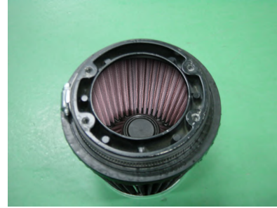
3: フィルターにファンネルアダプターを取り付け、バンドで締めます。
