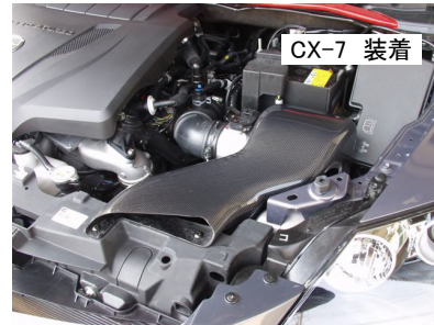
9: ラムエアインテークASSYを純正エアホースに差し込み車両に配置し、カーボンダクトケースをステアに仮組みします。(ビスA使用)
