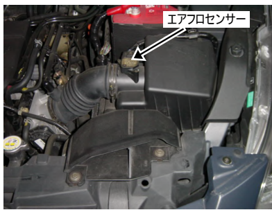
1: 純正エアホースのバンドを緩めます。エアフロセンサーのカブラーを取り外します。
