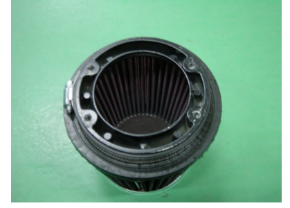
3: フィルターにファンネルアダプターを取り付け、バンドで締めます。
