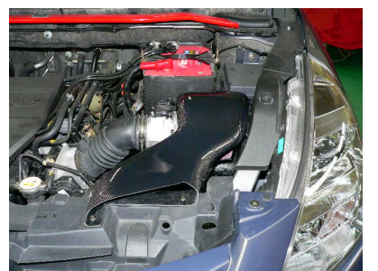
12: 各部、クリアランスを確認しながら増し締め固定します。
