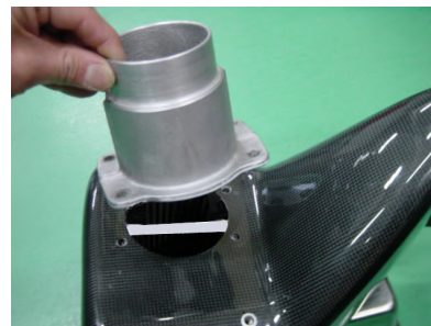
7: そのままエアフロアダプターを上から被せてビスAで取り付けます。
