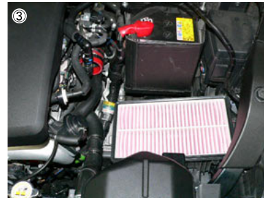
③ 上側のエアクリーナーケースカバーを取り外します。
