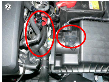
② エアフロセンサーカバー・エアインテークホースを取り外します。
