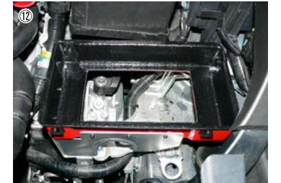
⑱ フィルターカバーをマウンティングブラバーを外したキャリアステーに配置します。
