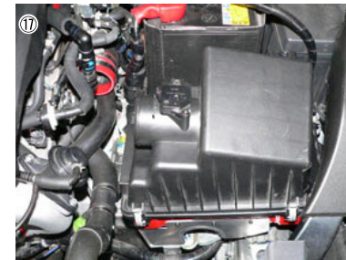
⑮ その上にエアクリーナーカバーを載せ、クリップで留めます。
