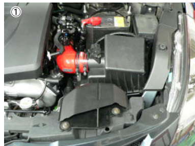
① ノーマルクリーナーケースを外すため、各パーツを取り外します。
