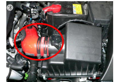
⑳ エアインテークホースを取り付け、エアフロセンサーカバーを元の通りに取付けます。
