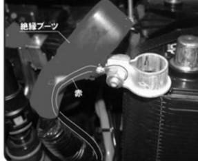
※バッテリーターミナルをバッテリーから外した状態で装着します。
