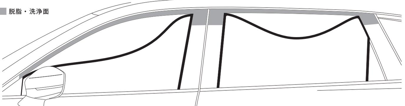
4. バイザー裏面の両面テープの離型紙を下図を参考に30mm程度剥がし、外側に折り曲げます。◎部のみ全て剥がします。
