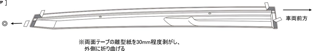
5. 下図の示す位置を参考に、フロントバイザーは後端をドアパネル後端から3mm、上端をドアパネルの上端に合わせ仮付けします。リアバイザーは、前端をドアパネル前端から3mm、上端をドアパネルの上端に合わせ仮付けします。
