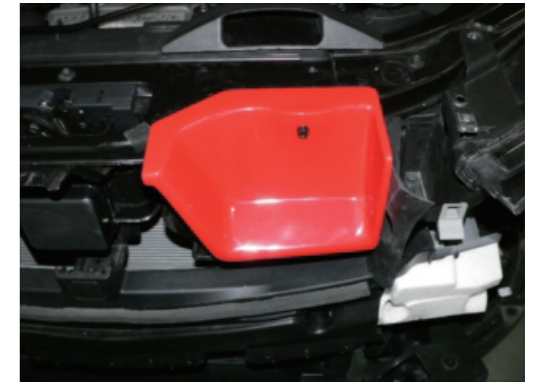
5. ホーンが固定されていた場所にスペーサー(小)をはさみ、ビスAでフレッシュエアガイド(ロア)を固定します。
