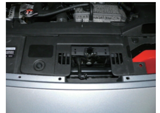
9. フロントバンパーを車両に復元し、切除加工したシルボードアッパーを車両に復元します。
