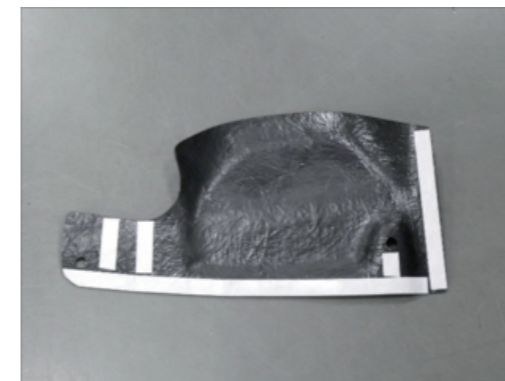
8. フレッシュエアダクト(アッパー)の図示部に両面テープを貼付し、剥離紙を剥がしておきます。
