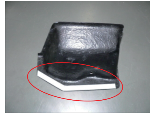
4. フレッシュエアガイド(ロア)の図示部に両面テープを貼付し、剥離紙を剥がしておきます。
