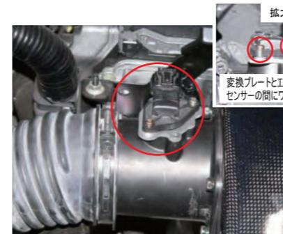
16. ビスDとワッシャーを使用してエアフローセンサーを取付けます。
