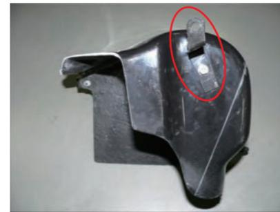
10. ステアCを写真の角度でビスAを使用してカーボンケースに仮留めします。
