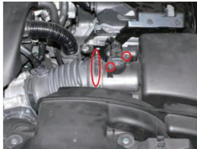
2. エアフローセンサー固定ビスを取外し、コネクタを接続したままエアフローセンサーを取外し、エアホースのホースクランプを締めます。
