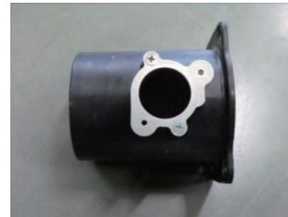
7. ビスCを使用して、エアフローアダプタに変換プレートを取付けます。
