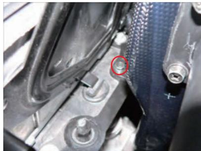
13. ビスAを使用してカーボンケースASSYを車両に取付けます。
