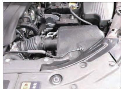
15. ボンネットロックステアを一旦戻し、カーボンケースと干渉がないかを確認します。(干渉する場合はステアを緩めて取付け位置を微調整を行ってください。)
