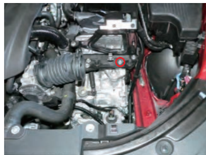
5. ○印部のボルトを取外します。 ※取外した純正ボルトは使用しません。
