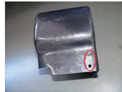
11. ビスBとナットを使用してステーAをカーボンケースに取付けます。
