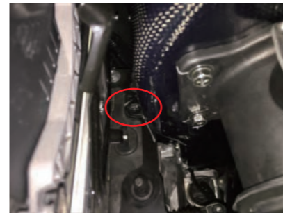
13. ビスCを使用してカーボンケースASSYを車両に固定します。
