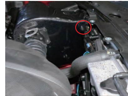
14. ビスBを使用してステーBとカーボンケースASSYを固定します。
