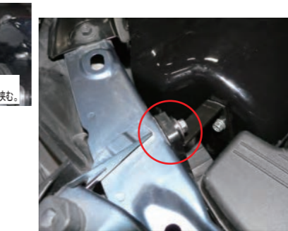
17. 純正ボルトを使用してカーボンASSYを車両に固定します。
