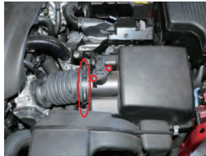
2. エアフローセンサー固定ビスを取外し、コネクタを接続したままエアフローセンサーを取外し、エアホースのホースクランプを緩めます。
