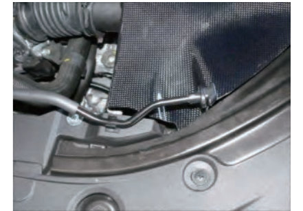
15. ボンネットロックステーを一旦戻し、カーボンケースと干渉しないかを確認します。(干渉する場合はステーを緩めて取付け位置の微調整を行ってください。)
