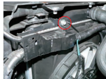
6. ○印部のボルトを取外します。 ※取外した純正ボルトは使用しません。
