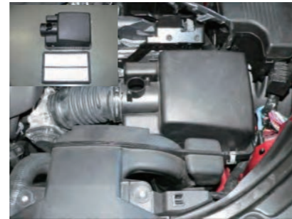
3. エアクリーナーカバーを取外し、エアクリーナーエレメントを取外します。
