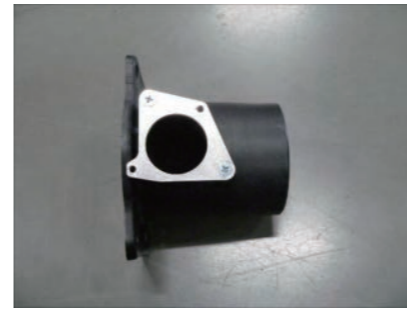
7. ビスEを使用して、エアフローアダプターに変換プレートを取付けます。
