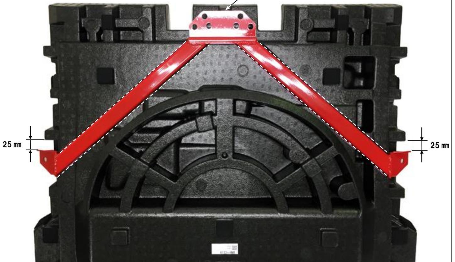
2. 1. でマーキングした線(破線部)のそれぞれ 5mm 外側に平行な線(実線部)を引きます。
