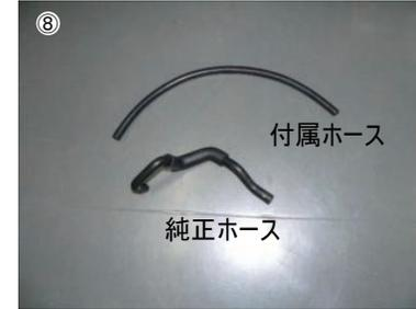
⑧ 純正φ6ホースを取外し、付属ホースと交換して取付けます。
