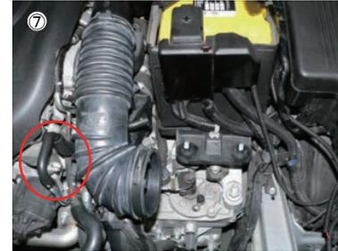
⑦ エアークリーナーカバーに接続していた図示のφ6ホースを車両から取外します。
