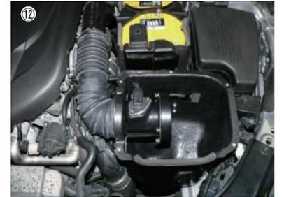
⑫ センサーパイプを純正エアホースに接続し、ホースクランプで固定します。
