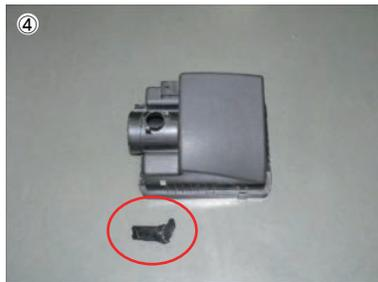
④ エアークリーナーケースから、エアフローセンサーを取外します。
