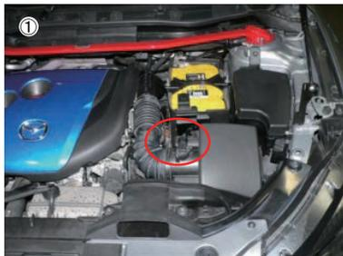
① エアフローセンサーのコネクターを切断し、エアホースのホースクランプを緩めます。
