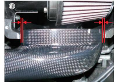
⑱ 左右の隙間を均等にしてフレッシュエアダクトを配置します。
