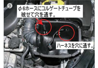
⑨ φ6ホースとエアフローセンサーハーネスを穴に通し、ロアカースを車両に取付けます。
