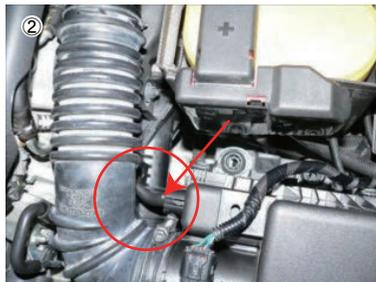
② エアークリーナーカバーに接続しているφ6ホースを切断します。
