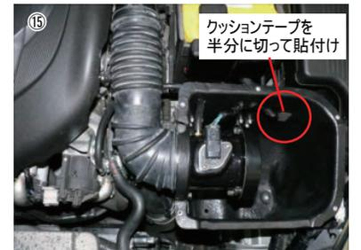
⑮ エアフローセンサーハーネスを通した穴の隙間にクッションテープを貼付けます。
