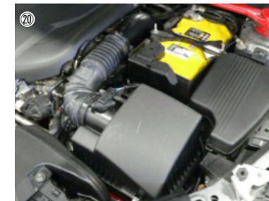
⑳ エアークリーナーケースからマウンティングラバー2個とクリップ2個を取外します。
