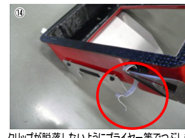
⑭ クリップが脱落しないようにプライマー等でつぶします。 ※この段階で一度フィルター、フィルターカバーを組付けて、クリップのテンションを確認してください。
