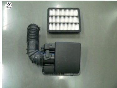
② エアホースごとエアークリーナーカバーを取外し、エレメントを取外します。
