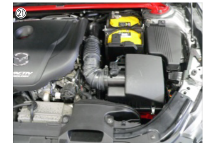
㉑ エアークリーナーケースからマウンティングラバー2個とクリップ2個を取外します。作業完了です。
