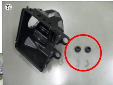
⑤ エアークリーナーケースからマウンティングラバー2個とクリップ2個を取外します。
