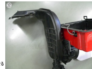
⑰ 写真のようにフレッシュエアダクトの溝にアルミステーBを挟むように乗せます。
