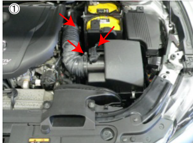
① エアフローセンサーのカブラーを外し、エアホースのホースクランプを緩めます。
