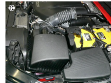
⑲ エアークリーナーカバー奥側の爪をブラケットAの穴に挿入してカバー閉め、クリップ2か所を固定します。
