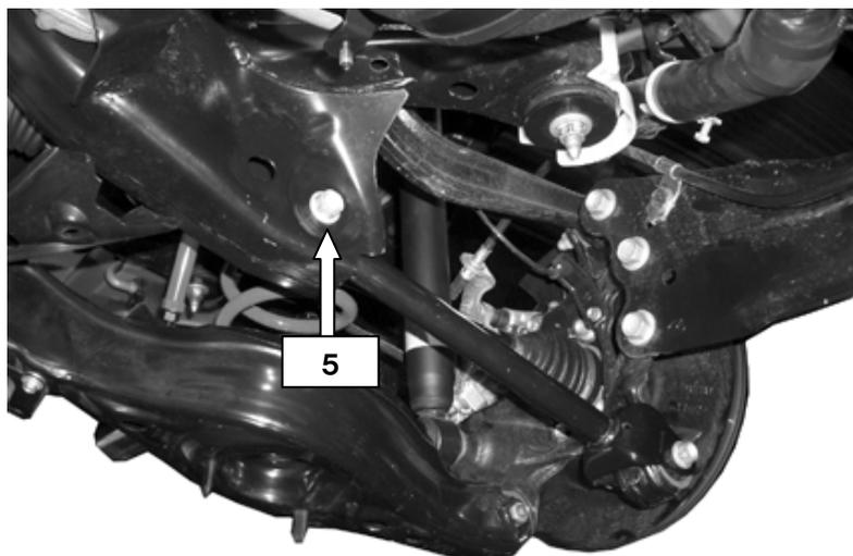
6. 付属の⑥⑦⑧ボルト、⑨⑩ワッシャー、⑪スプリングワッシャー、⑫ナット、⑭ナット付ステーを使用して、リヤメンバーブレースNo.2を取付けます。(図は助手席側です。運転席側も同様です。)
