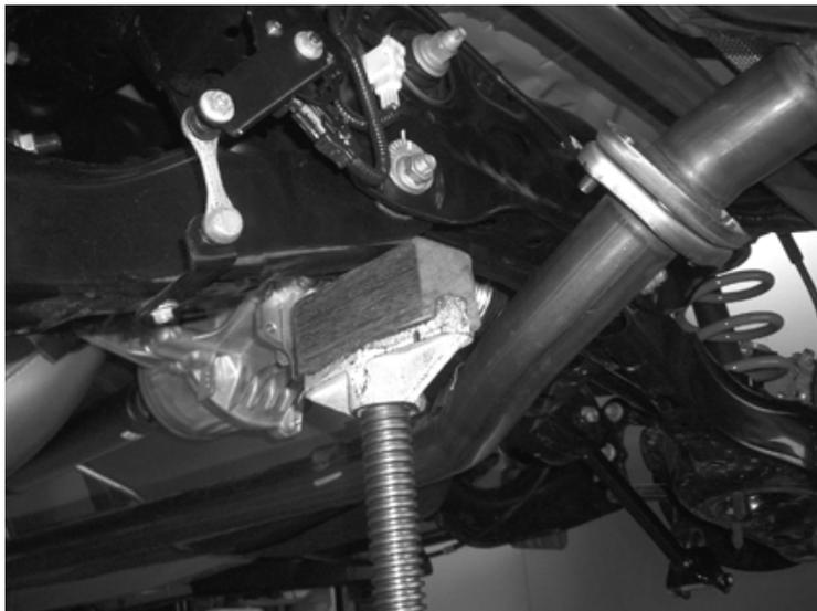
2. 図中②パーキングブレーキケーブルのステーを取外します。
