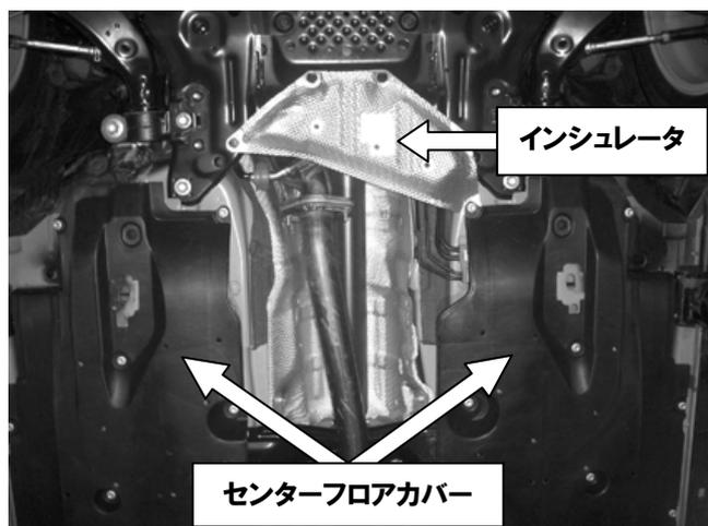
2. 図を参考にセンターフロアカバー・フロントの斜線部を切除加工します。
