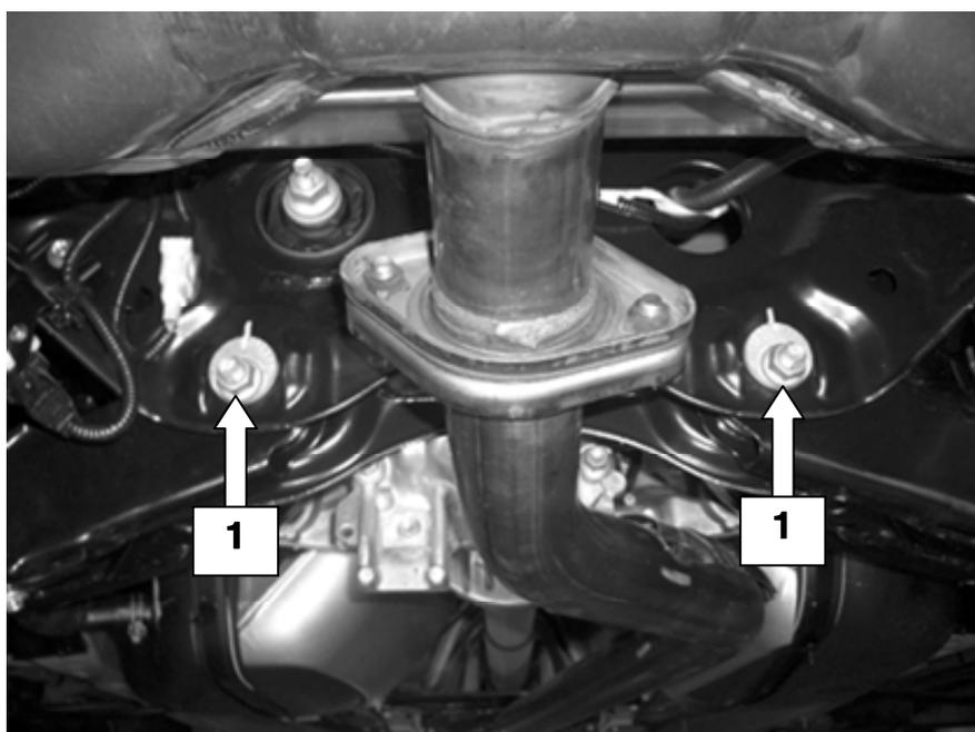
2. アジャストカムボルトに②スペーサーを取付けした後、①リアロアアームバーを車両に取付けし純正ナットを使用してロアアームバーを固定します。
