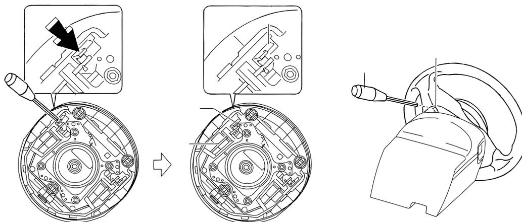
5. 下図に示す位置にステアリングホイールを回転させ、サービスホールからツールを挿入し、ツメの矢印部を押して、ツメおよびフック部の嵌合いを解除する。
