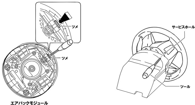
4. 下図に示す位置にステアリングホイールを回転させ、サービスホールからツールを挿入し、ツメの矢印部を押して、ツメおよびフック部の嵌合いを解除する。
