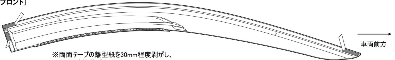
※両面テープの離型紙を30mm程度剥がし、外側に折り曲げる
