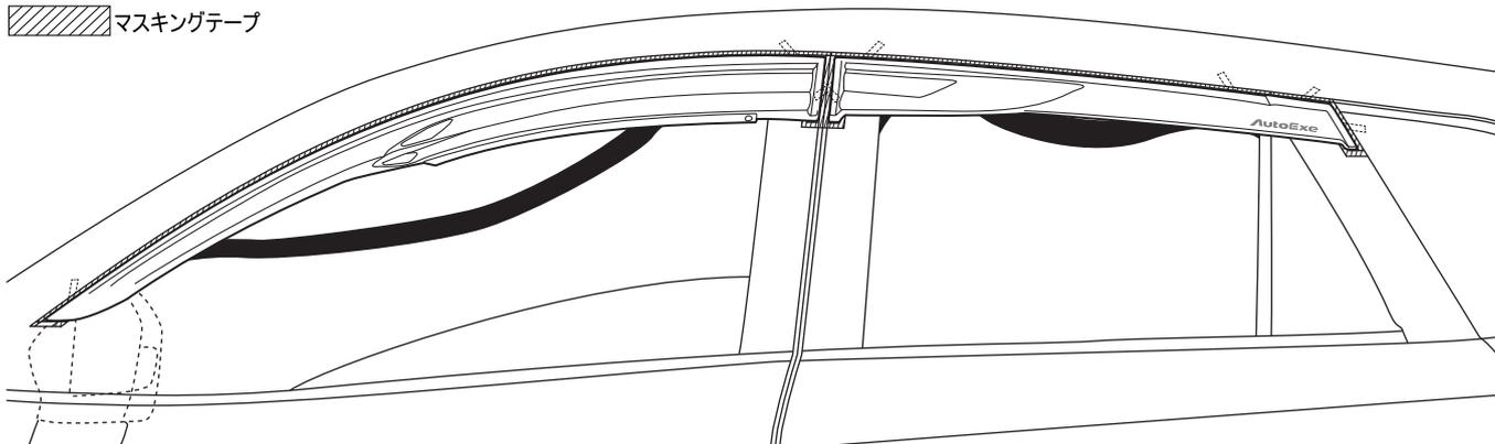
7. ②フロントバイザー、④リアバイザーを一旦外し、下図を参考にフロント・リアの外周から13mm内側にマスキングテープを貼付けます。
