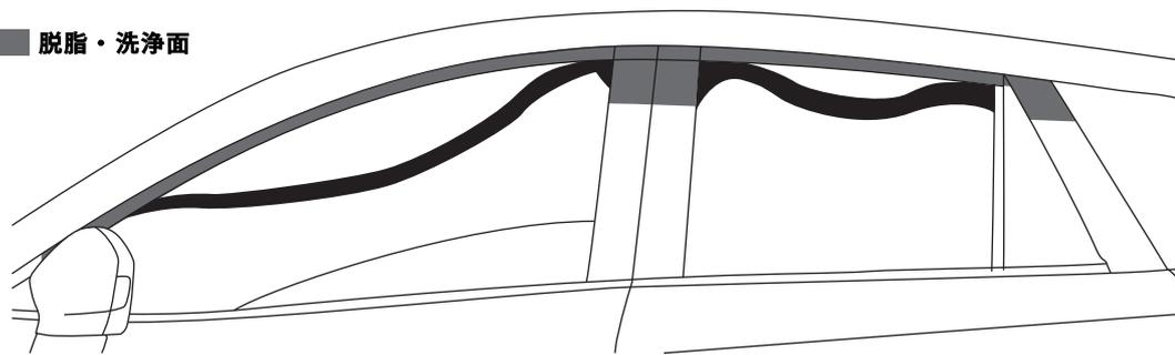
4. バイザー裏面の両面テープの離型紙を下図を参考に30mm程度剥がし、外側に折り曲げます。
