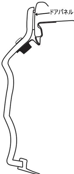
④リアバイザー 取付け断面図
