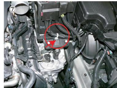
⑦ 配線留めを外し、バッテリー側へ押し込みます。
