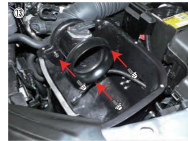
⑬ センサーパイプをロアケースにビスC、ナットで固定します。
