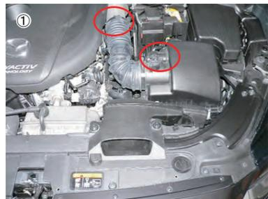
① エアフローセンサーのコネクターを切離し、エアホースのホースクランプを緩めます。
