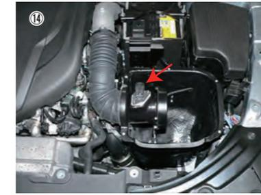
⑭ エアフローセンサーハーネスをエアフローセンサーに接続します。
