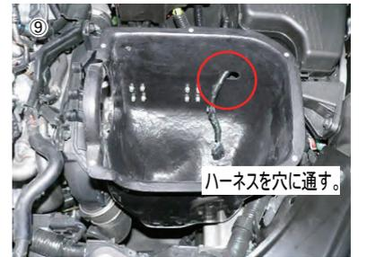
⑨ エアフローセンサーハーネスを穴に通し、ロアケースを車両に取付けます。
