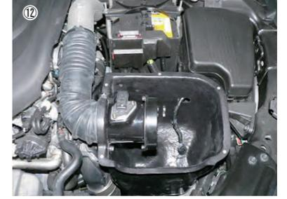
⑫ ロアケースの中からセンサーパイプを入れて純正エアホースに接続し、ホースクランプで固定します。
