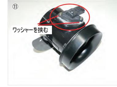
⑪ センサーパイプにワッシャーを挟み、エアフローセンサーをビスAで固定します。
