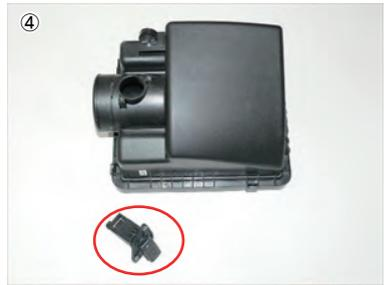
④ エアークリーナーカバーから、エアフローセンサーを取外します。
