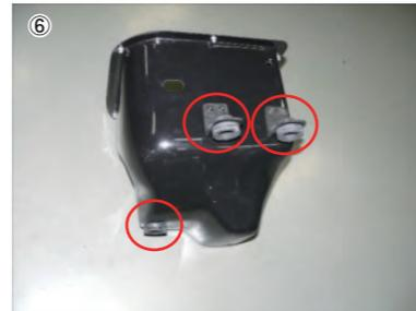
⑥ 樹脂ステーに純正マウンティングラバーを取付け後、ロアケースにビスBで取付けます。
