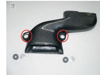
⑰ フレッシュエアダクトに純正のマウンティングラバーとスペーサーを取付けます。
