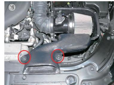
⑲ フレッシュエアダクトを車両に配置して、純正ボルトで固定します。
