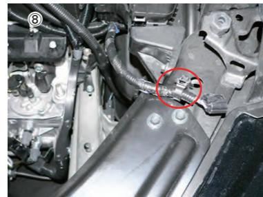
⑧ エアフローセンサーハーネスの固定クリップをハーネスから外します。
