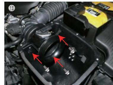
⑬ センサーパイプをロアカースにビスC、ナットで固定します。
