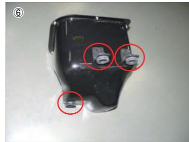
⑥ 樹脂ステーに純正マウンティングラバーを取付け後、ロアカースにビスBで取付けます。
