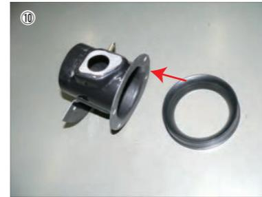
⑩ アダプターをセンサーパイプにビスCで固定します。
