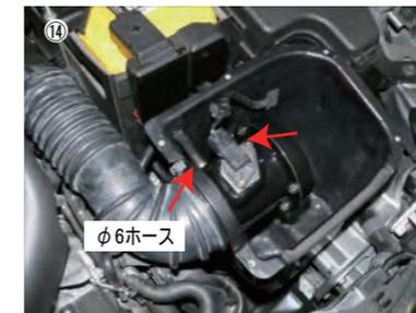
⑭ φ6ホースをセンサーパイプに接続します。エアフローセンサーハーネスをエアフローセンサーに接続します。
