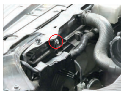
6. O印部のボルトを取外します。 ※取外した純正ボルトは使用しません
