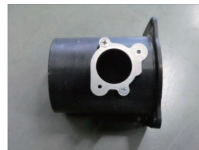
7. ビスC使用して、エアフローアダプタに変換プレートを取付けます。
