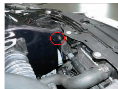
14. ビスAを使用してステア-BとカーボンケースASSYを固定します。
