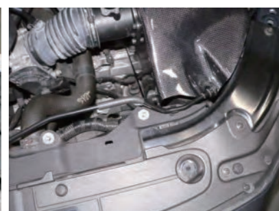
15. ボンネットロックステーを一旦戻し、カーボンケースと干渉がないかを確認します。(干渉する場合はステアを緩めて取付け位置を微調整を行ってください。)
