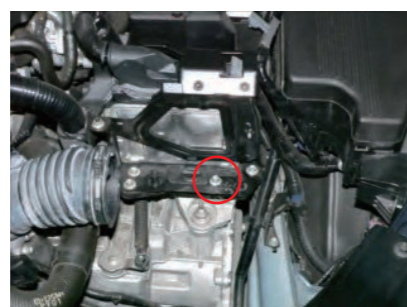
5. O印部のボルトを取外します。 ※取外した純正ボルトは使用しません
