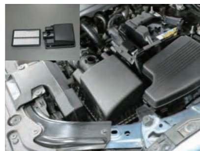
3. エアークリーナーカバーを取外し、エアークリーナーエレメントを取外します。
