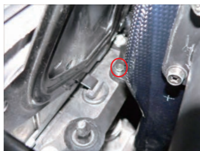
13. ビスAを使用してカーボンケースASSYを車両に固定します。
