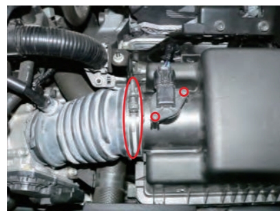
2. エアフローセンサー固定ビスを取外し、コネクターを接続したままエアフローセンサーを取外し、エアホースのホースクランプを締めます。
