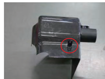
10. ビスAとナットを使用してステア-Aをカーボンケースに取付けます。
