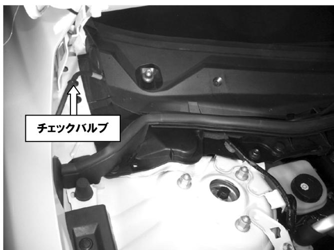
3. ストラットを固定しているナット6個とカウルパネルを固定しているボルト4個、コネクターとクリップを取外します。
