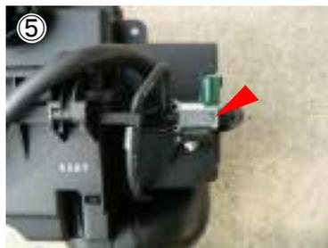
⑤ ソレノイドバルブからホースを抜き取り、付属のφ4キャップを差し込み、バルブ本体を取り外します。
