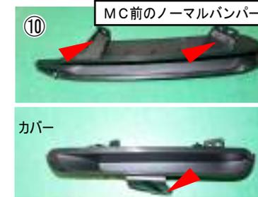
⑩ MC前のノーマルバンパーカバーは上側がタッピングビス2箇所、下側はアンダーカバーと共に締められて固定されています。
