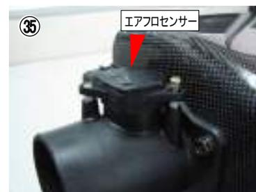
㉜ エアフロアダプターにエアフロセンサーを取り付けます。(ビスC、M4スペーサーを使用)
