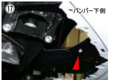
⑰ 導入ダクト先端部(空気導入口)をステーで仮固定します。
