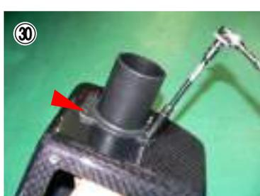
㊴ フィルターケース外側からエアフロアダプターを合わせて、ボルトで仮固定します。矢印部はステアと共締めなので後で付けます。
