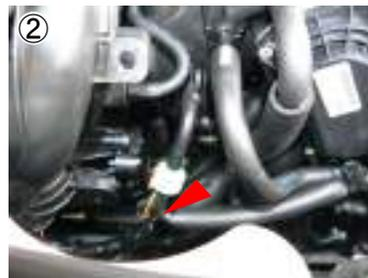
② クリーナーケースに配管されているホースをワンウェイバルブ部分から抜き取り、付属のφ4キャップを差し込みます。
