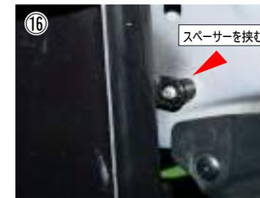
⑯ レゾナンスチャンパーを固定していた後側のスタッドボルトにスペーサー10mmを挟み、ノーマルナットで仮固定します。
