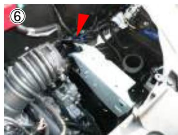
⑥ ソレノイドバルブを元の通りにカブラーに差し込み、周辺にある車両ハーネス類にタイラップで共留めします。
