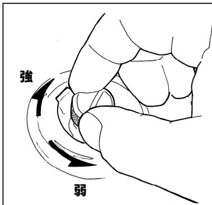
アジャスターを強くする方向いっぱい締め込んだ状態が最強になります。この時、軽く締め込んで下さい。締め込み過ぎると内部パーツが破損し調整できなくなる恐れがあります。
