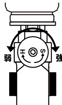
リアの減衰調整は、リアショック下部にある調整ノブで調整します。
