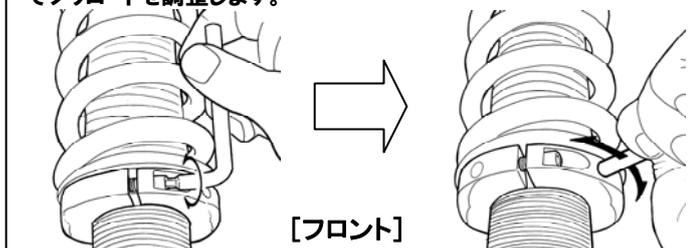
付属のロックレンチを使用してプリロードを調整します。調整する際はあらかじめボトムケースが固定されているアーム類から取り外す必要があります。また、ボトムケースとダンパー本体のカミシロは10mm以上確保してください。
