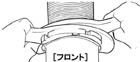
③L型レンチでロックボルトを緩めロアシートを回して車高を調整します。アジャスターとスプリングシートのカミシロは、最低10mm以上を必ず確保してください。
