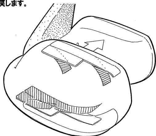
※両面テープの接着力を確保する為、接着面を完全に脱脂し40°程度に暖めてください。
