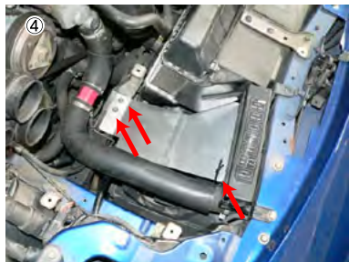
ヒートプレートAを取り付けます。エンジン側は純正ボルトで共締め固定。ヒューズボックス側はヒートプレートにタイラップ中を通し、ラジエーターファンカバーに留めます。
