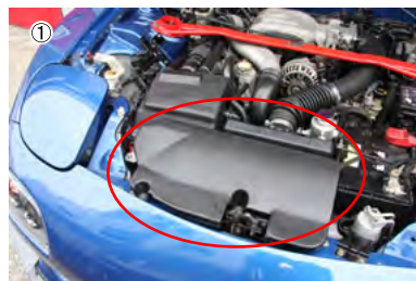
フレッシュエアダクトを外します。
