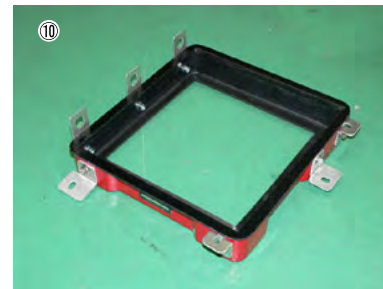
⑩ フィルターカバーにブラケット、ステー類を取り付けた完成状態。
