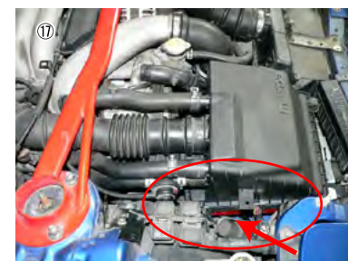
⑰ 各部、クリアランスに注意して固定します。
