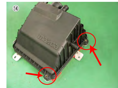
⑭ M6-30mmビス、ナットを使用して固定します。
