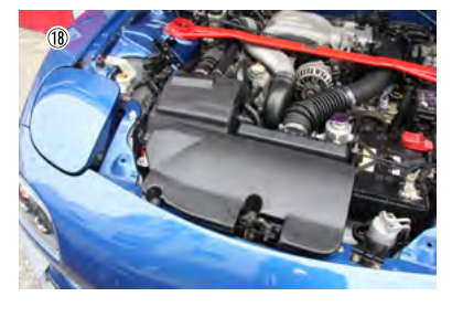
⑱ フレッシュエアダクトを元の通りに取り付けて、作業完了です。
