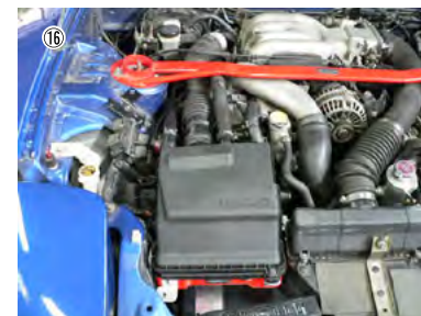
⑯ ホース類を取り付けて、ステーで固定します。
