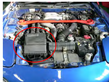
ホース類のバンドを緩め、エアクリナーASSYを取り外します。
