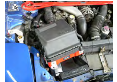
⑮ 組み立てたインダクションボックスASSYをエンジンルーム内に配置します。
