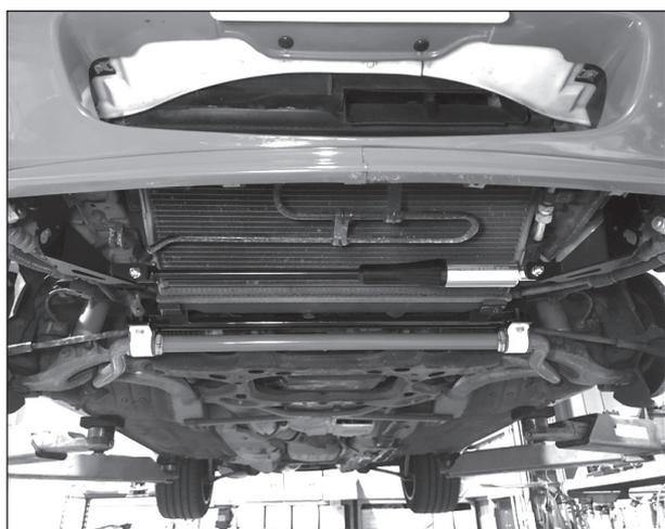
1. 車両をジャッキアップし、フロントタイヤ左右、およびフロントアンダーカバーを取外します。
