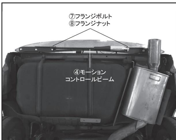
4. ⑦フランジボルト、⑧フランジナットを使用して、④モーションコントロールビーム(リア用)を⑤⑥リアブラケットに仮付けします。
