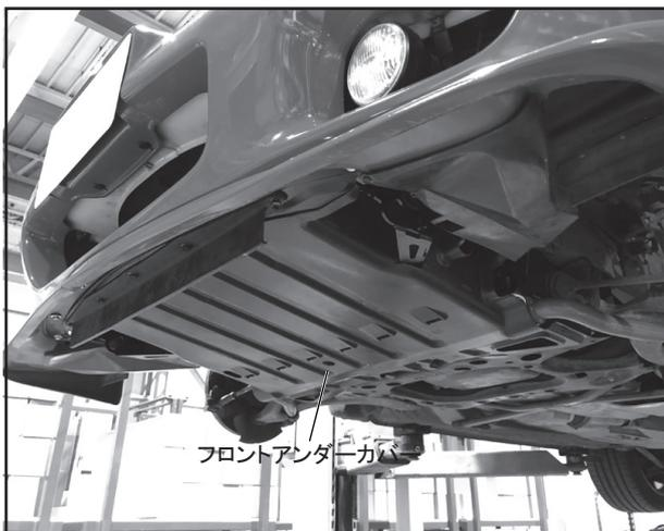
6. 加工したフロントアンダーカバーとフロントタイヤ左右を車両に復元します。
