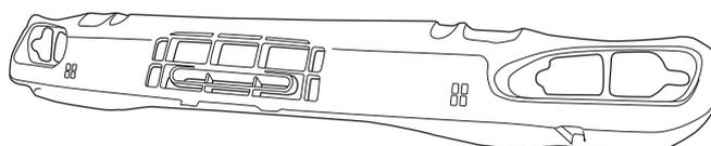
レインフォースメントは切除加工および不要部品を取外し後、再度車両に取付けます
