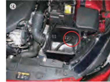
⑭ エアフローセンサーハーネスを穴に通し、ロアケースを車体に取付けします。
