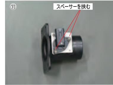
⑪ エアフローアダプターにスペーサーを挟みエアフローセンサーをビスCで固定します。
