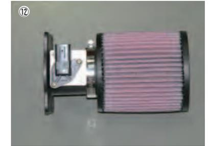
⑫ エアフローアダプターにエアフィルターを取付け、ホースバンドで固定します。
