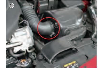
⑱ アッパーケースをロアケースに被せて配置し、エアホースを接続し、クランプで固定します。
