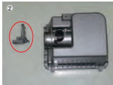
② エアークリーナーカバーを取外し、エアフローセンサーを取外します。
