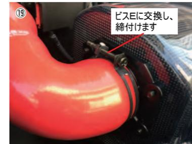
⑲ インテークサクシジョンキットと同時装着する場合は、ホースクランプのボルトをビスEに交換し取付けます。
