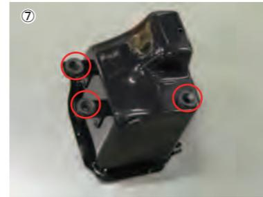
⑦ ロアケースと樹脂ステーに純正マウンティングラバーを取付けます。
