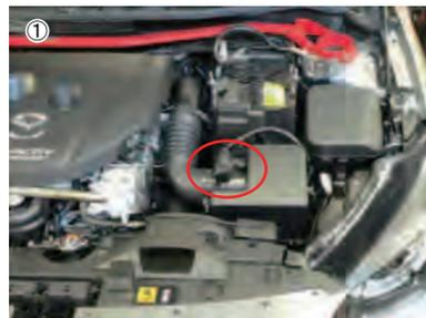
① エアフローセンサーのカバーを取外し、エアホースのホースクランプを緩めます。
