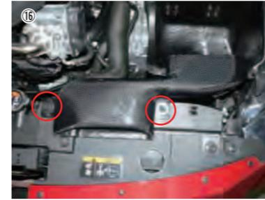
⑯ フレッシュエアダクトを車体に配置して、純正ボルトで固定します。
