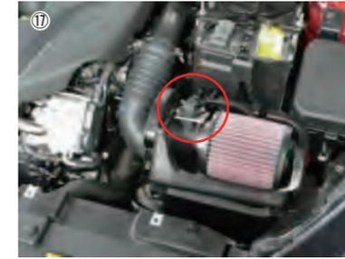
⑰ エアフローセンサーハーネスをエアフローセンサーに接続します。
