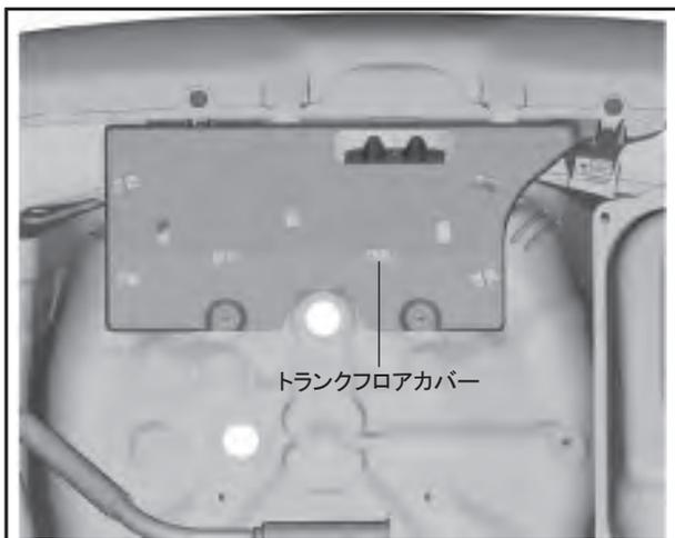
4. トランクフロアカバーを車両に復元して作業完了です。
