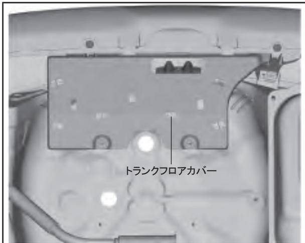
1. リアバンパー下端に取付けされているトランクフロアカバーを取外します。
