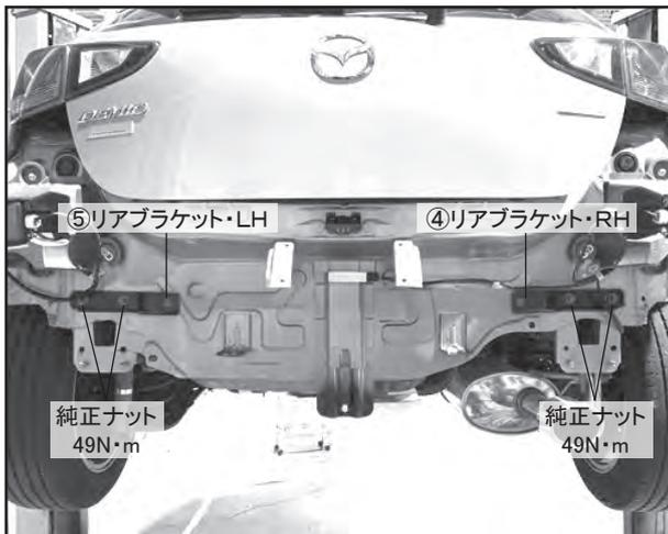
2. 図示部にある純正ナット4個を取外し、④⑤リアブラケットを車両に固定します。
