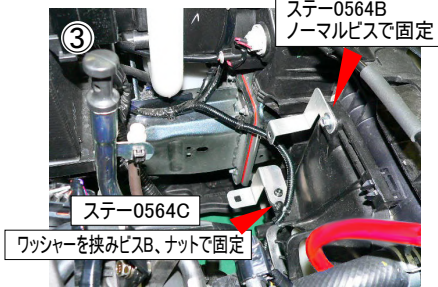
③ ラジエターリザーバタンクを移動させるためステーを取り付けます。
