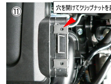
⑪ チャンバーケース接続部の穴位置にマーキングし、ノーマルクリーナーケースに3mmの穴開加工をします。穴開加工後の穴にクリップナットを差し込みます。
