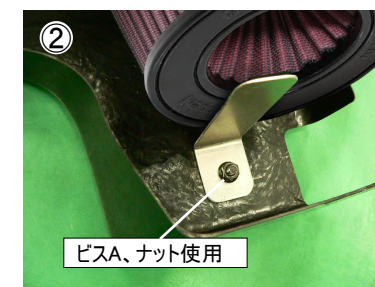
② フィルターを支えながらステー-0564Dをフィルタートップに宛がうように取り付けます。
