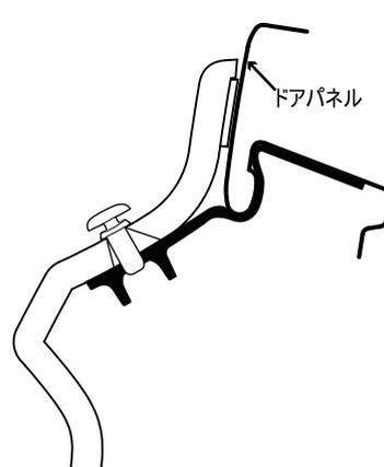
フロントバイザー先端差し込み詳細図
