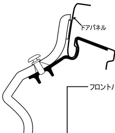
リアバイザー取付け断面図
