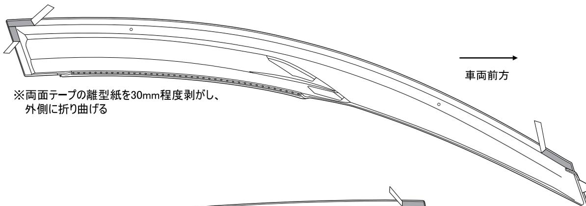
※両面テープの離型紙を30mm程度剥がし、外側に折り曲げる
