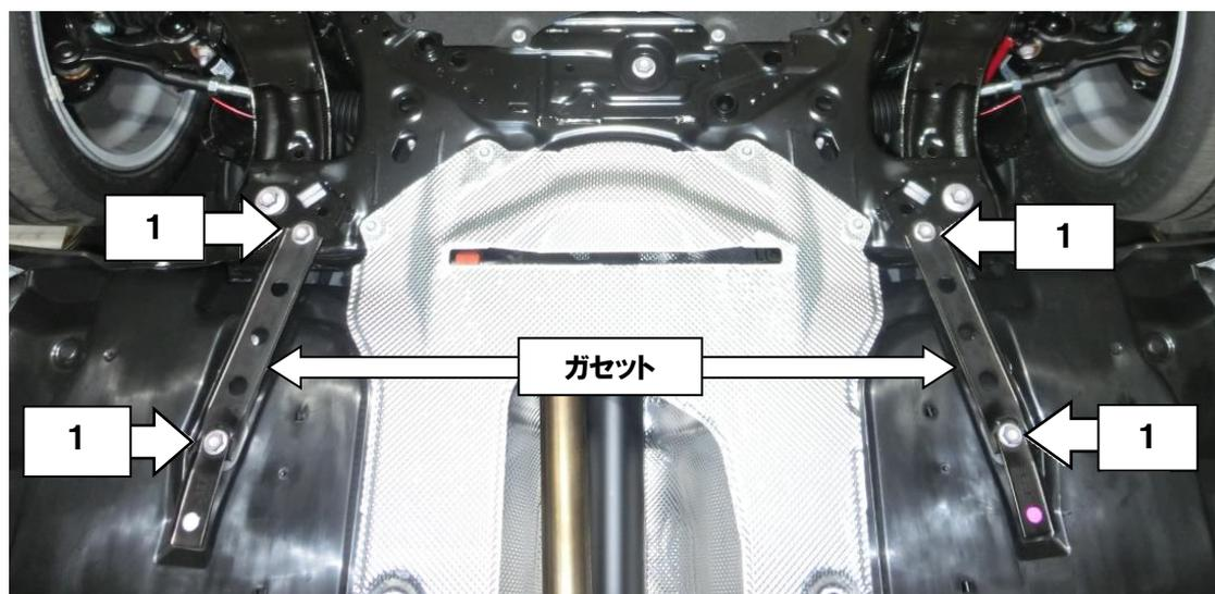
2. ①ロアアームバー(フロント)をサスペンションメンバーと純正ガセットの間に挟み、取外した純正ボルトで仮組みします。
