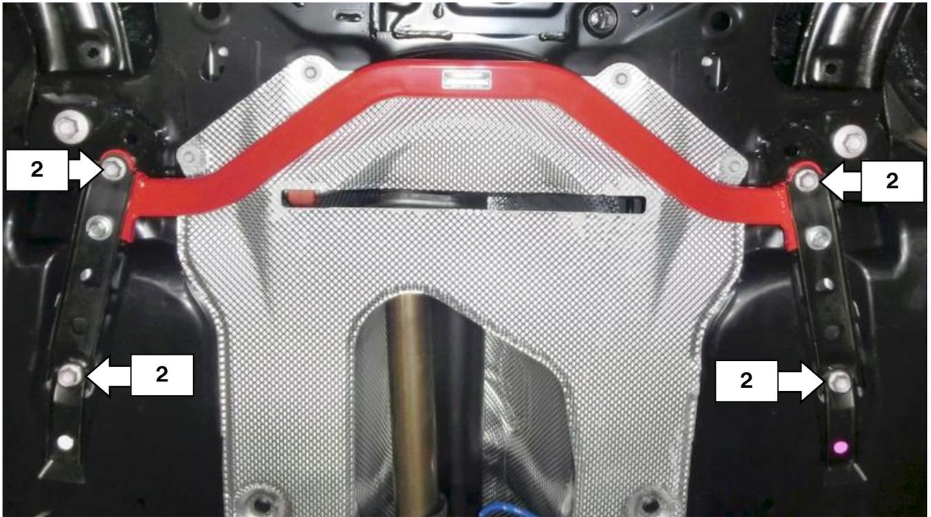
3. 図示の部分を、②ボルト、③スペーサー、④フランジナットで仮組みします。
