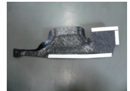
12. フレッシュエアダクト(アッパー)の図示部に両面テープを貼付し、剥離紙を剥がしておきます。
