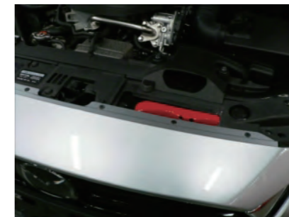
11. フロントバンパーを車両に復元し、切除加工したシールドボードアッパーを車両に復元します。
