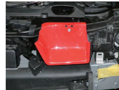
8. ホーンが固定されていた場所に純正ボルトでフレッシュエアガイド(ロア)を固定します。
