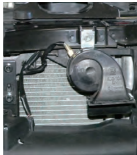
2. 車両からホーン(LH)を取外します。
