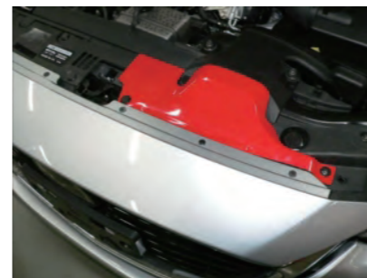
13. 純正ファスナーとボルトを使用して、フレッシュエアダクト(アッパー)を車両に固定します。
